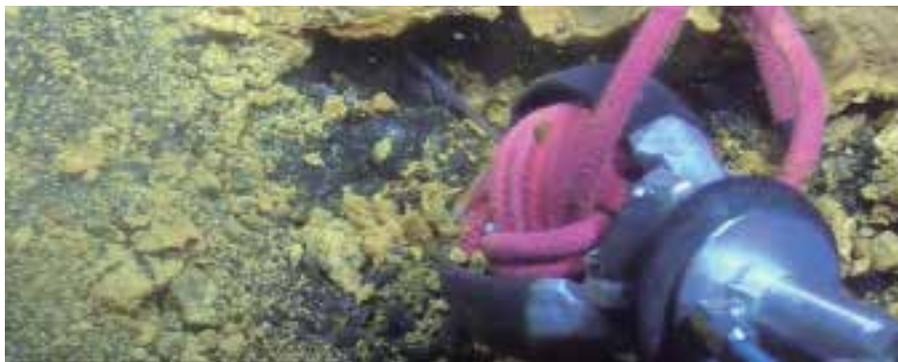
Medición de la temperatura del fluido hidrotermal a 129 metros de profundidad. IEO
