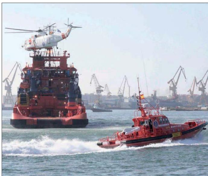
drocarburos “Urania Mella”, el primer barco anticontaminación propio, con una capacidad de almacenamiento de residuos de 3.100 M<sup>3</sup>. Con la incorporación de este buque recogedor a la flota de Salvamento Marítimo la capacidad de almacenamiento y recogida de residuos se incrementa hasta los 7.260 metros cúbicos, lo que supone multiplicar por 90 la capacidad existente en 2004, que era tan sólo de 80 metros cúbicos.
