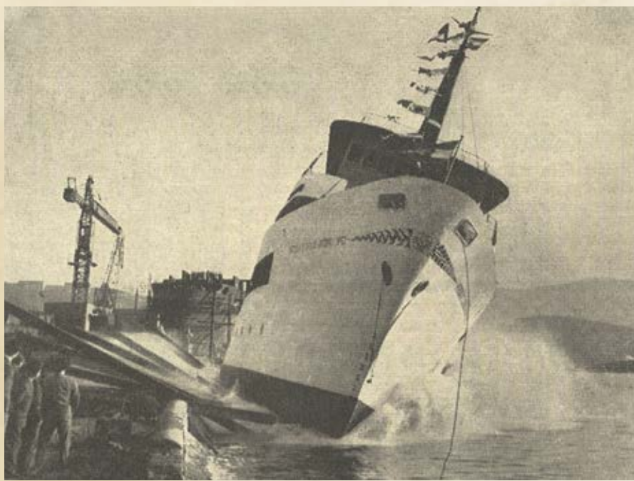
El fotógrafo bilbaíno ha captado con gran oportunidad el momento en que es botado, de costado, el mercante “Presidente Carlos Antonio López”, construido en astilleros vizcaínos para la flota de Paraguay.
