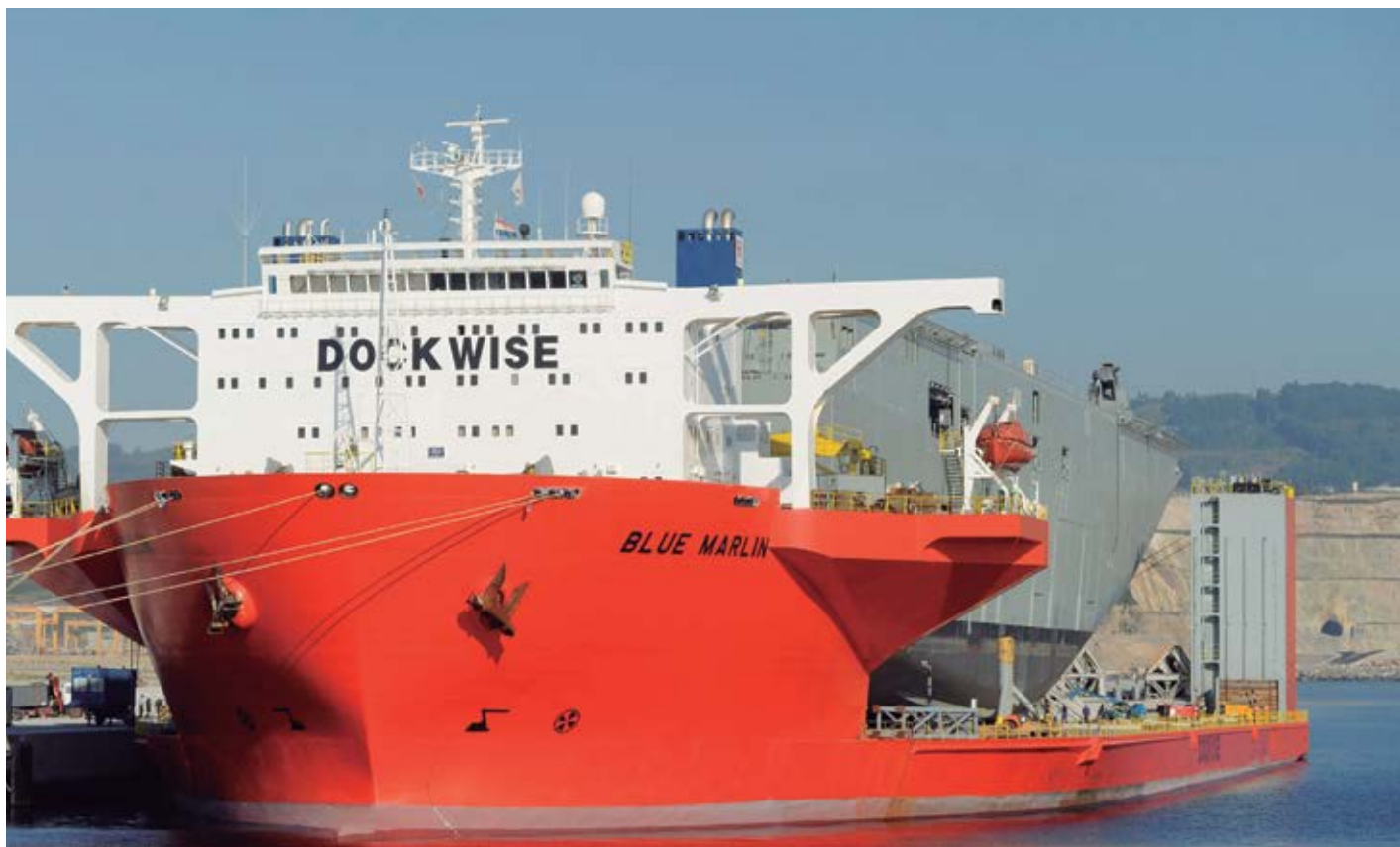
El buque de proyección Camberra, construido en Navantia Ferrol, fue conducido por el "Blue Marlin" hasta Australia, donde fue completada su construcción.
