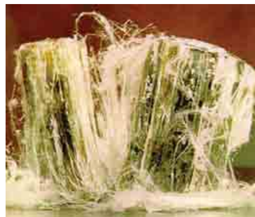
Detalle de fibra de amianto
