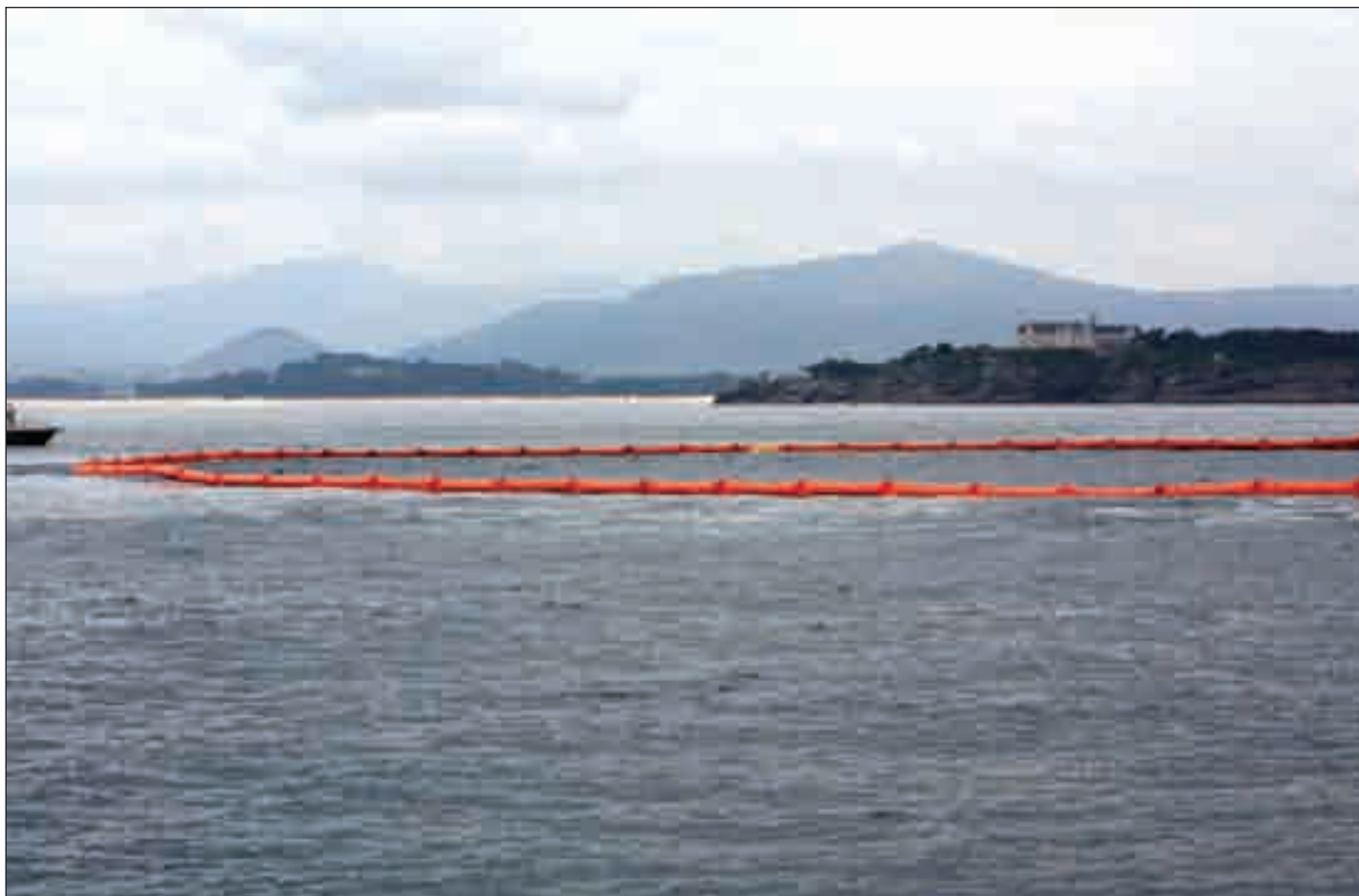
Las barreras anticontaminación pueden ser oceánicas o de litoral, en función de donde se detecta la mancha que hay que atajar. Foto: Ana Munguía
