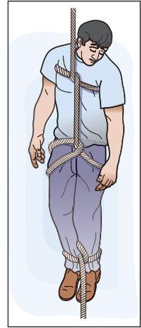
Figura 7-103: Izado con un cabo.
