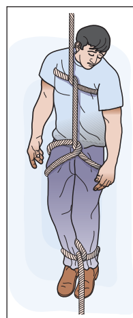
Figura 7-103: Izado con un cabo.
